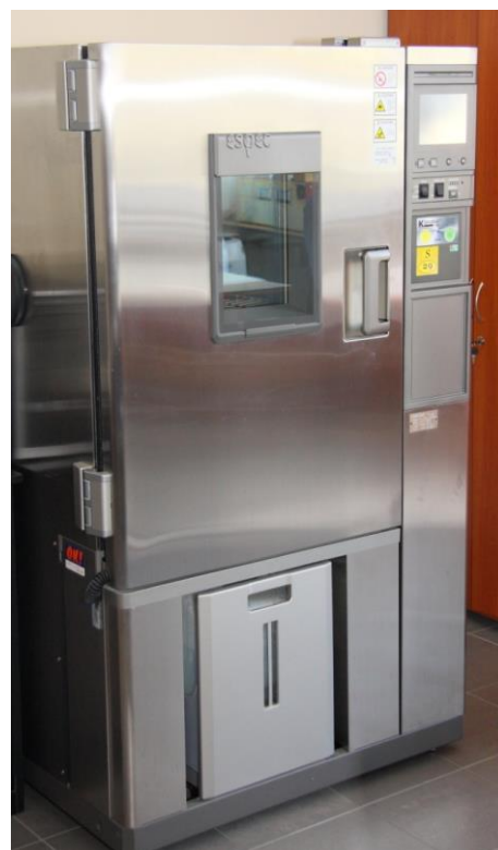
Komora klimatyczna PL-2KPH, służąca do sprawdzania odporności na wilgotność i temperaturę. Zakres pomiarowy: Zakres temperatury -40 do +150°C, Zakres wilgotności 20 do 98 %RH, Pojemność 225 l, Dokładność przestrzennego rozkładu temperatury \pm 1.5^{\circ}\text{C} , Szybkość zmian temperatury wg normy PN-EN 60068-3-5: 3°C/min dla grzania, 2°C/min dla chłodzenia
