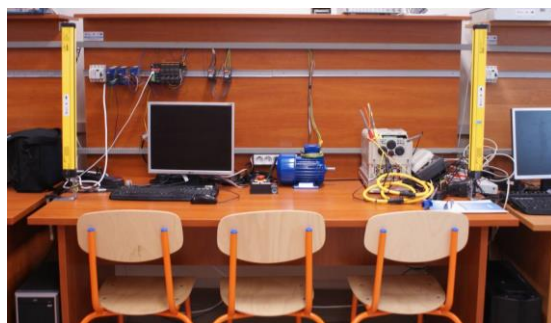
Stanowisko z programowanymi systemami bezpieczeństwa i analizatorem parametrów napięć prądów zasilania
