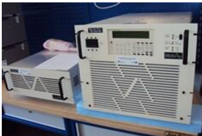
Programowalne źródło mocy AC 3120-ASX 12kVA firmy Pacific :
