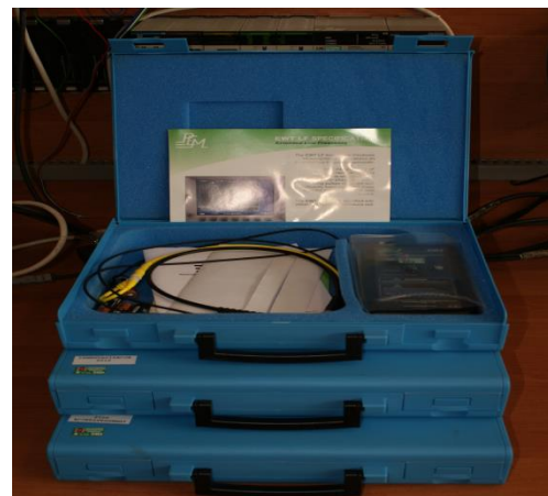
Zestaw sond CWT z giętkimi i cienkimi końcówkami umożliwiającymi pomiar prądów na nóżkach tranzystorów w falownikach mocy
