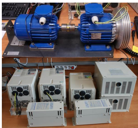
Zestaw falowników napięcia do zadań specjalnych umożliwiające zaawansowane sterowanie pracą maszyn asynchronicznych, synchronicznych oraz z magnesami trwałymi wektorem pola magnetycznego w pętli otwartej oraz z wykorzystaniem sprzężeń zwrotnych
