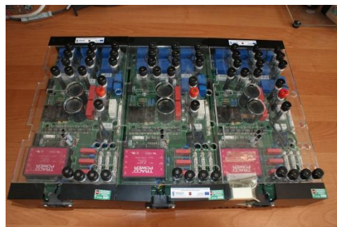
Zestaw trzech programowalnych falowników napięcia wraz z wbudowanymi przetwornikami do pomiaru napięć i prądów po stronie DC i AC
