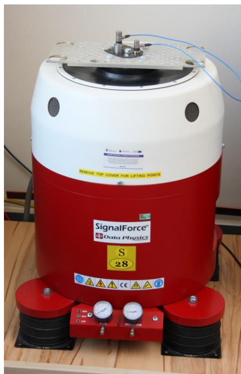
Wstrząsarka SignalForce. Max. uder 6672 N, przy szer. impulsu 3 ms, przysp. 93 g drgania i udary od 0 do 5 kHz.
